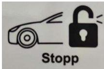
3. Beenden des Ladevorgangs über zweimaliges Aufschließen des Fahrzeugs (zuerst das Ladekabel am Auto entfernen) oder erneute Autorisierung an der Ladestation
